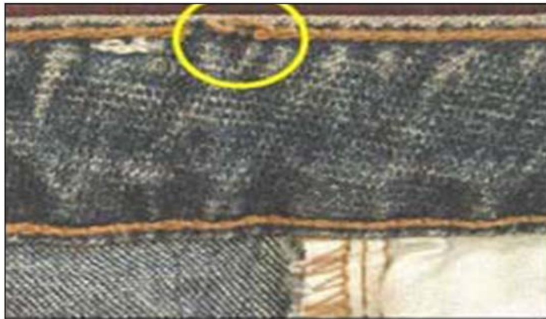
Fig: Unraveling seam
